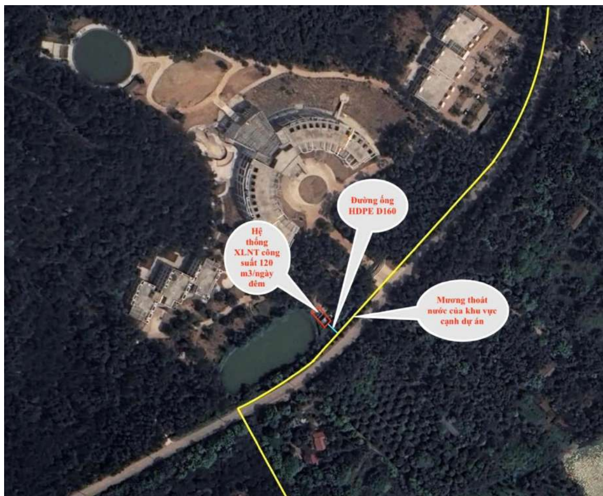
Hình 3.5-Sơ thoát nước thải sau HTXL NT ra nguồn tiếp nhận
